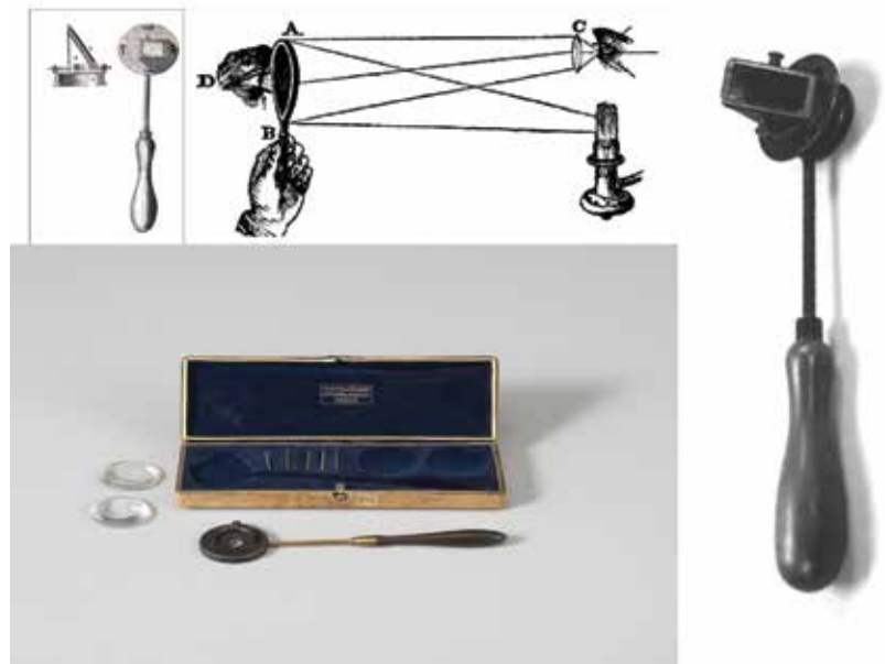
Figura 2. Primer Oftalmoscopio de von Helmholtz y esquema de su funcionamiento ( https://www.teylersmuseum.nl/nl/collectie/instrumenten/fk-0898-ophthalmometer-in-doojsje-oogspiegel ).
