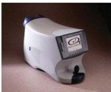
El aparato proyecta un haz luminoso que atraviesa la CFN y es reflejado, modificando su estado de polarización según el espesor del medio atravesado. Este cambio del estado de polarización se denomina retraso. Existe una relación directamente proporcional entre el espesor de la CFN y el cambio de polarización sufrido por el haz, pudiendo estimar así el espesor de dicha CFN.
