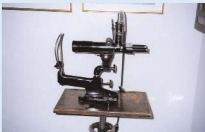
**E**l aparato tiene un acabado sorprendente para la época en que se hizo y está impecable. Para que pudiera funcionar tiene cambiado el transformador y la lámpara, ya que de fábrica venía para corriente continua, aquí inexistente.
